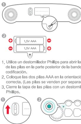
1. Utilice un destornillador Phillips para abrir la tapa de las pilas en la parte posterior de la bandeja de codificación.
